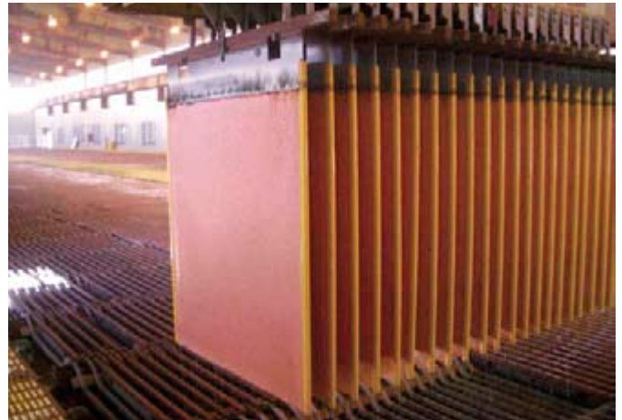
Cosechando cátodos de Duplex en el centro de ensayos de Arizona
